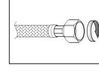
ナット付コネクターは手でしっかりと締めつけてから、適合するレンチで締めつけてください。ゴムパッキンの場合は、締めすぎに注意してください。
