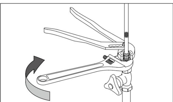
③ フレキシブルホースが動かないようにレンチ等で押さえながらナットをスパナ等で増し締めします。締め付けトルクは目安として (シートパッキン) 5 ~ 7N・m です。
