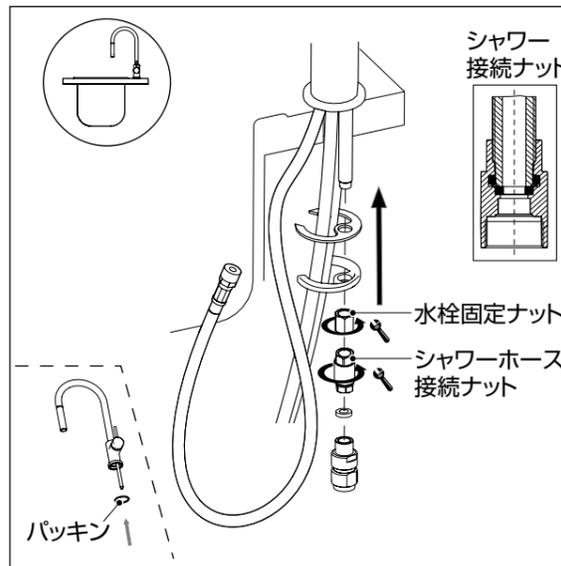
②台座にパッキンをセットした後、ホースを取り付け穴に差し込みます。
