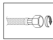
ナット付コネクタは手でしっかり締めつけてから、適合するレンチで締めつけてください。
