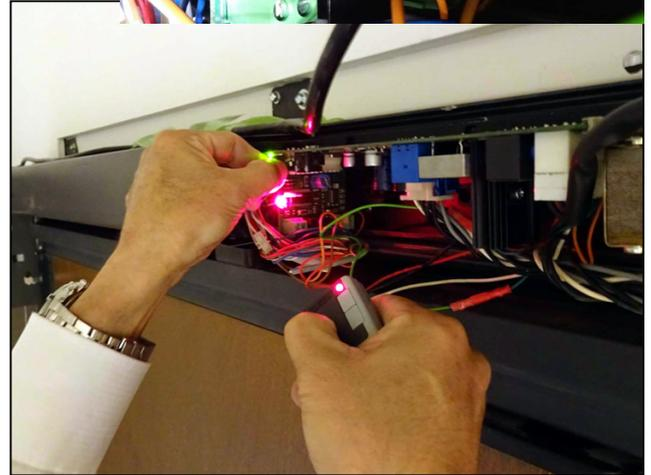
⑥ 設定ボタンとリモコンボタン（設定していた任意のボタン/通常は左上）を同時に長押しします（5秒）。※このときガレージ受信機とリモコンの赤色ランプが点灯します。
