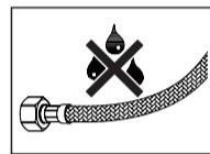
設置後のホースは、いかなる物質も接触し続ける状態にしないでください。ホースの損傷や破裂をまぬく恐れがあります。
