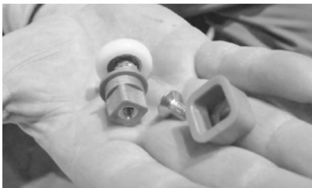
③先にローラーをガラスフレームのレール部分へはめ込んだ上で、前と同じ要領でローラーをスライドガラスに取付けてください。
