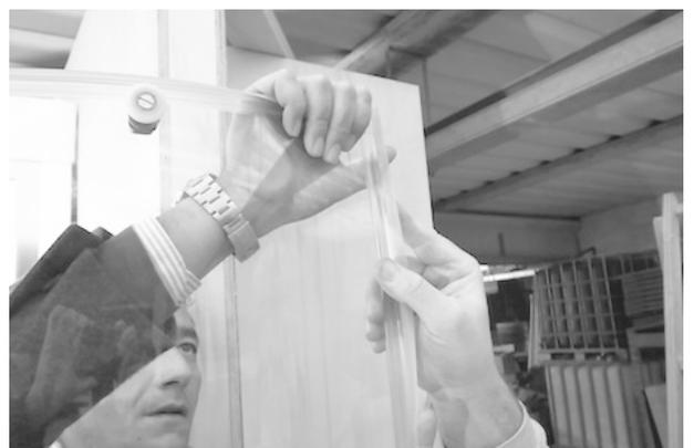
⑩左スライドガラスにも同じ要領で、上端にパッキン（短）、右端にパッキン（長）を取り付けます。（ヒダ部分を外側に）
