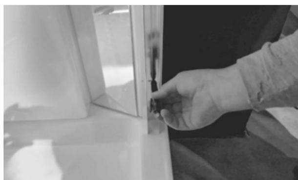
④サイドC型フレームを一旦どかして、先程印を付けた箇所にM3ドリルで穴を開けます（上下共）
