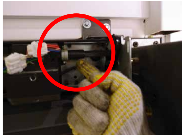
④ 駆動ジョイントの黒色部分を外側方向にスライドさせます。
