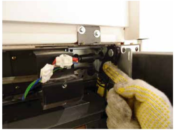
⑧ 潤滑剤の塗布が終わったら、駆動ジョイントを元に戻します。
