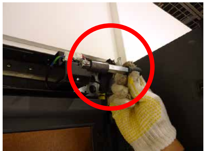
⑥ 駆動ジョイント部品を手前に引き出して、これのみを取り出します。
