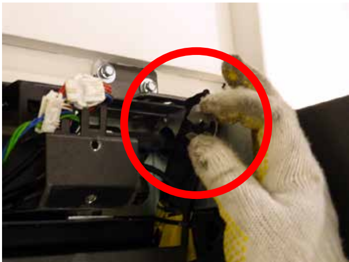
③ 右端のシャフト部分のワッシャーを外します。
