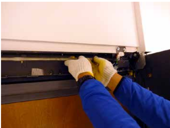
⑤ 連結シャフトの外側端部のみを手前に引き出して外します。
