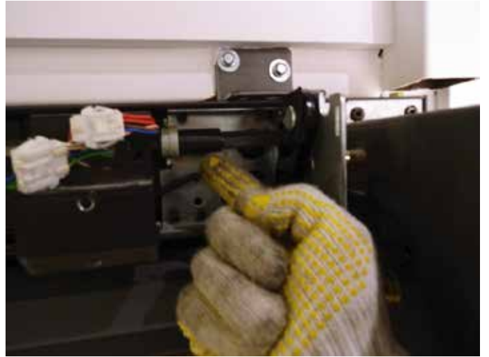
⑩ 駆動ジョイントの黒い部分を内側方向にスライドさせ、ワッシャーも忘れずに元に戻しましょう。
