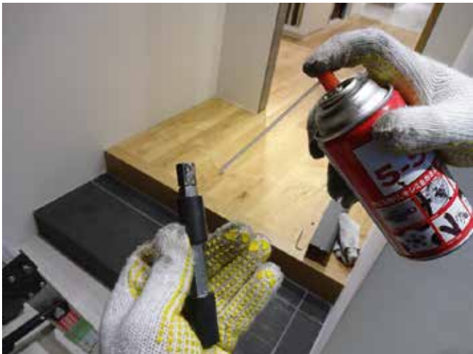
⑪ 反対側の駆動ジョイントも同じ手順で洗浄してください。
