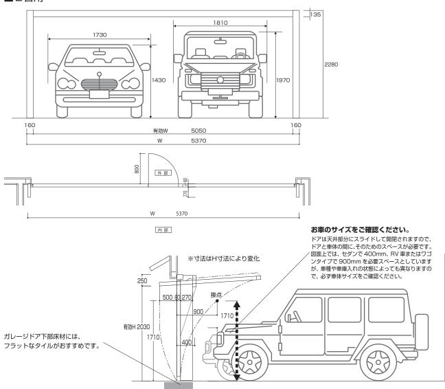
ボトムゴムと床材が擦れ合うことは必ず避けてください。擦れ合うことで生じる摩擦は、ゴムカバーを破損させ、センサーに支障をきたす原因になります。
